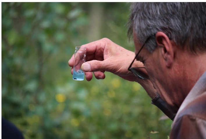
Fig. 30. Hay kits de prueba disponibles para medir con precisión las características del agua como la alcalinidad. Estos no requieren calibración, son relativamente económicos, y proporcionan un sistema de respaldo útil para las unidades electrónicas.
