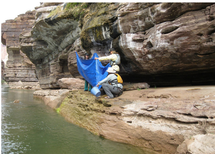
Fig. 29. Los agrimensores ocasionalmente deben improvisar para medir el flujo. En este caso, el grupo usó una lona para coleccionar gotas en un manantial jardín colgante en la orilla del Río Colorado en el Gran Cañón, Arizona.
