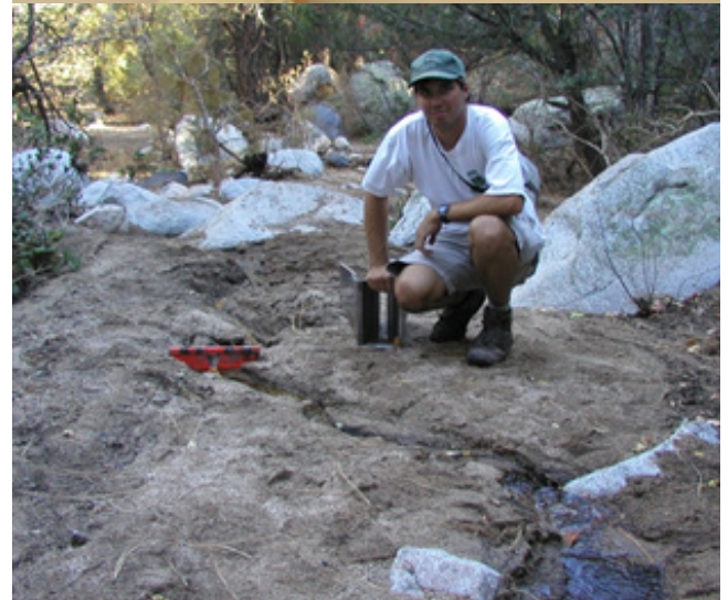
Fig. 24. Los hidrólogos usan una placa de vertedero de pared delgada en V para medir flujos de bajo volumen en un sustrato suave.
