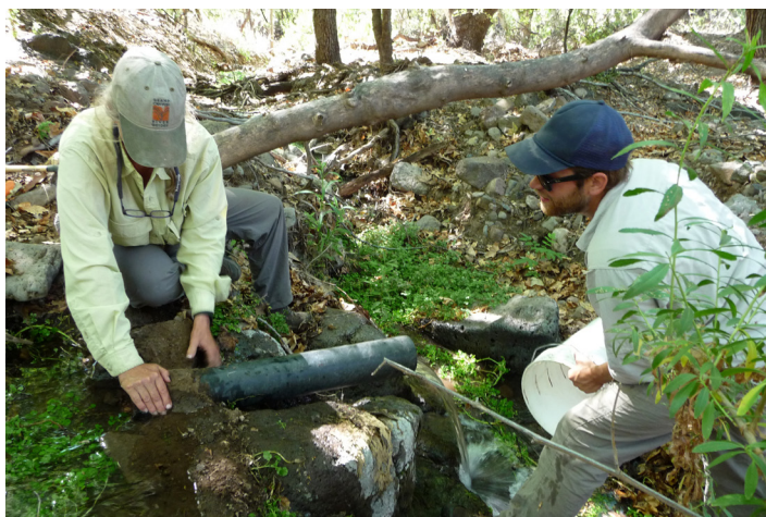
Fig. 27. Los miembros del grupo miden el flujo creando una presa con tierra, o en este caso con heces de vaca, para dirigir el flujo a través de un tubo.
