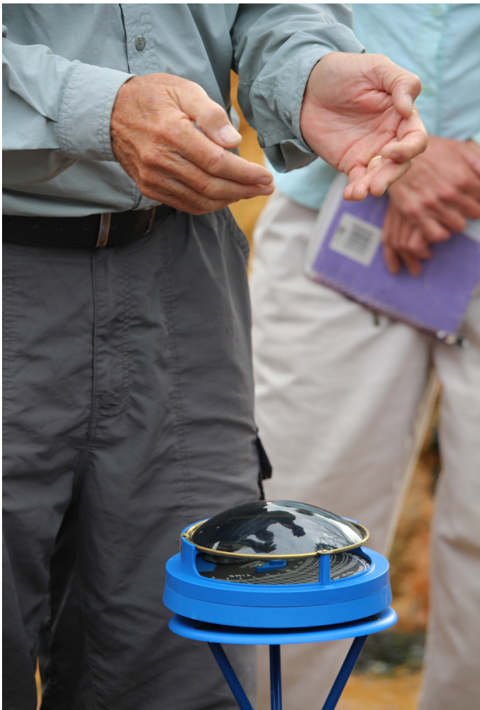
Fig. 12. El Solar Pathfinder es utilizado para medir la radiación fotosintéticamente activa en un ecosistema de manantiales.
