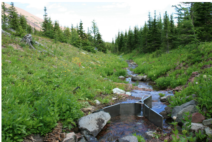
Fig. 26. Los canales de aforadores son útiles para entornos más desafiantes. Aunque son “portátiles”, son pesados y difíciles de usar en sitios remotos. Este canal aforador se utilizó para medir el flujo en un manantial recreo en Canadá.
